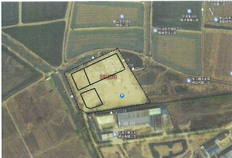
◎-有组织废气采样点; ○-无组织废气采样点; ★-废水采样点; ▲-工业企业厂界环境噪声检测点
